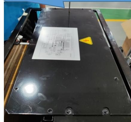
Ziehen Sie die Steuerplatine des Lüftermotors ab Sinalkabel
